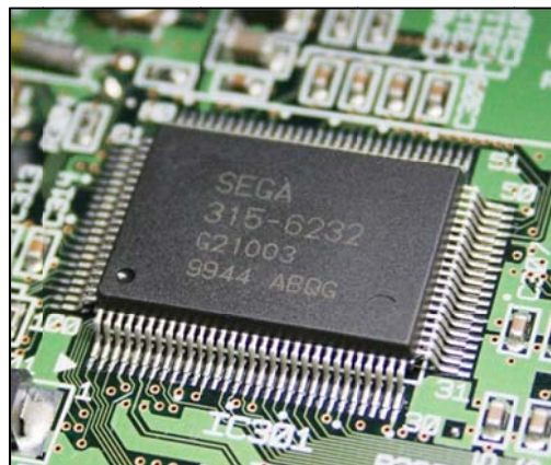
Photo n°1 : Le Yamaha Super Intelligent Sound Processor 2 , DSP équipant la console de jeu Sega Dreamcast, sorti en 1998
